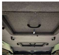
Дополнительный люк на крыше
