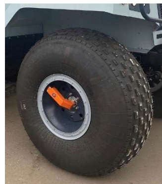
Рис.20.33 Система централизованной подкачки колёс
