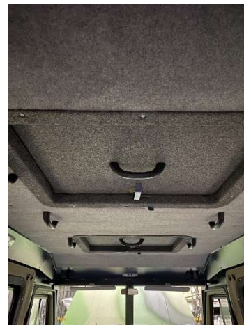
Рис.20.36 Дополнительный люк на крыше
