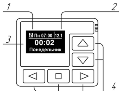
Рис. 20.17 Внешний вид пульта управления ПУ-40: 1 – активированный таймер запуска, 2 – напряжение питания, 3 – LED индикатор, 4 – кнопки управления.
