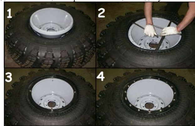
Рис. 10.4 Порядок монтажа шины ТРЭКОЛ
